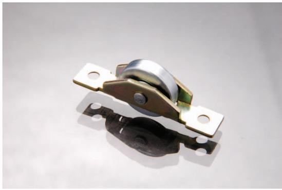
Fabricado en chapa de acero laminado en frío calibre 16. Con rodamiento de D 17,4 mm liso. Esta diseñado para instalarse en puertas corredizas sencillas o dobles, bibliotecas, bares, estantes entre otros. Lleva un baño electrolítico de Zinc Azul.
