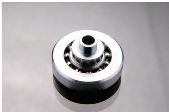
Fabricado en acero 1020 - D 1", emplea esferas de acero de D 5/32". Es utilizado como accesorio corredizo en la fabricación de herrajes gavetas de madera. Acabado con baño electrolítico de Zinc Azul. También se fabrica en versión con "canastilla". (Dispositivo plástico porta esferas).
