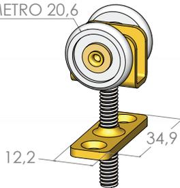
Fabricado en chapa de acero laminado en frío calibre 18. Con recubrimiento electrolítico en Zinc Iris. Es un rodamiento liso de 2 ruedas en Nylon de D 20,6 mm.
