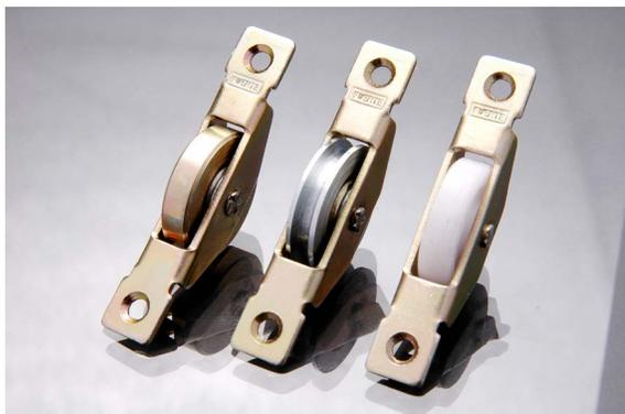
Fabricado en chapa de acero laminado en frío calibre 16. Rodamiento D 25,4 mm ranurado, ancho de la ranura 3,5 mm, profundidad de 2,5 mm, remachada al cuerpo de la rodachina. Lleva un recubrimiento electrolítico de Zinc Azul.
