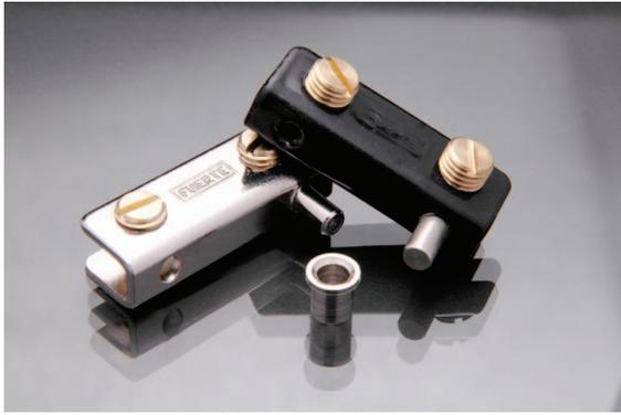
Fabricada en chapa de acero laminada en frío calibre 14. Con recubrimiento electrolítico de Níquel. Con protectores de caucho en los tornillos que permiten ajuste completo a la hoja de vidrio. Esta diseñada para puertas con peso hasta de 15 kg.
