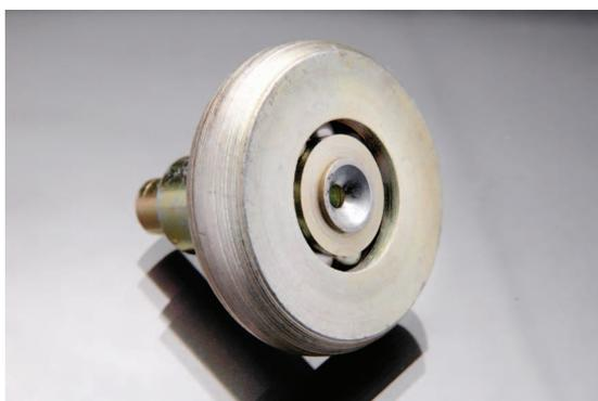
Fabricado en acero 1020 - D 47,4 mm con eje de 47 mm de longitud. Emplea esferas de acero de 1/4". Protegido contra la oxidación con recubrimiento electrolítico de Zinc Iris. Es utilizado en puertas automáticas de garaje.
