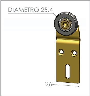
Fabricado en chapa de acero laminado en frío, calibre 14. Con recubrimiento electrolítico de Zinc Iris. Con rodamiento en Nylon de D 7/8" sobre buje. Para puertas medianas y pequeñas.
