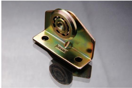
Fabricado en chapa de acero laminado en frío calibre 14. Con recubrimiento electrolítico de Zinc Iris. Rodamiento de D 1". Se utiliza en puertas sencillas desde  $\frac{3}{4}$ " hasta  $1\frac{3}{4}$ " de espesor.
