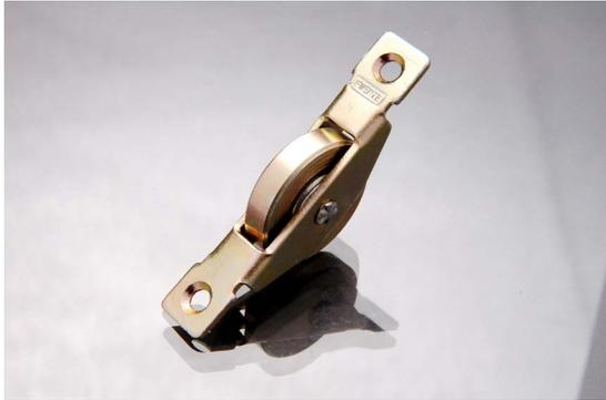
Fabricado en chapa de acero laminado en frío calibre 16. Con rodamiento de D 25,4 mm liso. Esta diseñado para instalarse en puertas corredizas sencillas o dobles, bibliotecas, bares, estantes entre otros. Lleva un baño electrolítico de Zinc Azul.
