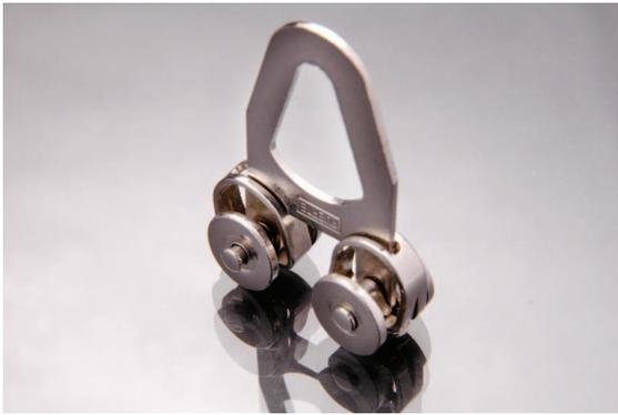
Fabricado en acero laminado en frío, con recubrimiento electrolítico de Níquel. Herraje corredizo para guardarropas, que con su riel reemplaza la barra en la cual cuelgan los vestidos. Se utilizan de 15 a 20 por metro.
