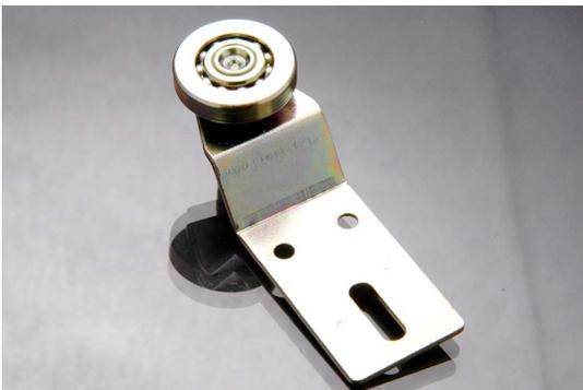
Fabricado en chapa de acero laminado en frío calibre 14. Con recubrimiento electrolítico en Zinc Iris. Con rodamiento de D 1", tamaño pequeño, utilizable en puertas muy sencillas, bipartidas y pasantes.
