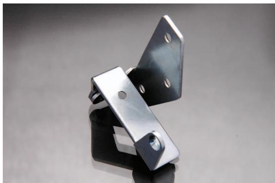
Fabricada en chapa de acero laminada en frío calibre 14. Con recubrimiento electrolítico de Zinc Azul contra la corrosión. Permite un ángulo máximo de apertura de 180°. Después de instalada queda una parte a la vista. Especialmente usada en puertas de cocinas integrales. Esta diseñada para puertas con peso hasta de 20 kg.
