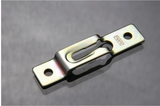
Fabricada en chapa de acero laminada en frío calibre 16. Herraje especial que se utiliza para cuadros y anclaje de muebles. Con recubrimiento electrolítico de Zinc Iris.
