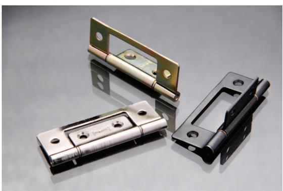
Fabricada con chapa de acero laminada en frío calibre 18. Con recubrimiento de Zinc Iris. Permite un ángulo máximo de apertura de 180°. Esta diseñada para puertas con peso hasta de 15 kg.
