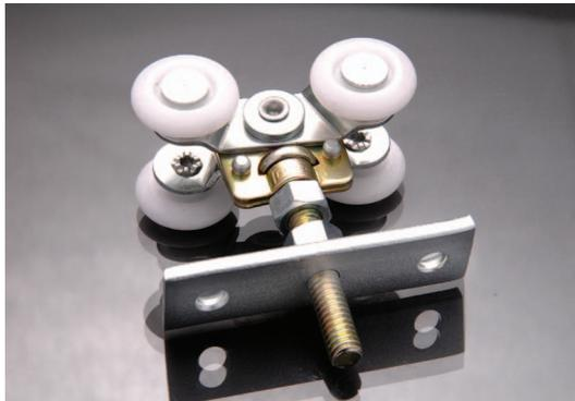
Fabricado en chapa de acero laminado en frío calibre 14. Con recubrimiento electrolítico de Zinc Azul. Diseñada con 4 brazos escualizables y 4 ruedas de D 1" de Nylon (rodamiento silencioso). Utilizables en puertas corredizas, pasantes o bipartidas.
