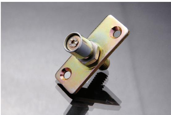
Fabricada en chapa de acero laminada en frío calibre 12. Con recubrimiento electrolítico de Zinc Iris. Especial para guiar puertas medianas; cuenta con un sistema giratorio y de graduación.
