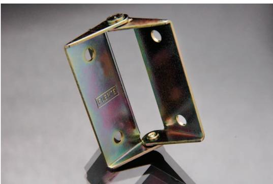
Fabricada en chapa de acero laminada en frío calibre 18. Tiene un recubrimiento electrolítico de Zinc Iris. Especialmente diseñadas para puertas plegables y de biombo. Esta diseñada para puertas con peso hasta de 50 kg.
