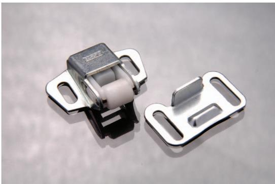
Este tope esta compuesto por 2 elementos. El cuerpo Porta-Nylon fabricado en chapa de acero laminado en frío calibre 18. Tiene un rodillo de Nylon resortable que sirve como elemento de fijación a la otra parte del tope mecánico. Fabricado con lámina del mismo calibre. Los dos elementos sirven para cerrar herméticamente las puertas sin necesidad de otro tipo de tope (magnético). Posee un recubrimiento electrolítico de Zinc Azul que los protege de la corrosión.
