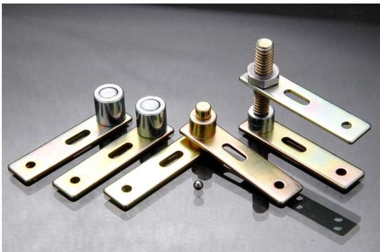
Fabricado en chapa de acero laminado en frío calibre 16 y aceros redondos de diferentes diámetros, con recubrimiento electrolítico de Zinc Iris. Está compuesto por siete elementos que instalados en los bordes de las puertas se acomodan en forma de fuelle. Se usa en combinación con la bisagra ref. B-90.
