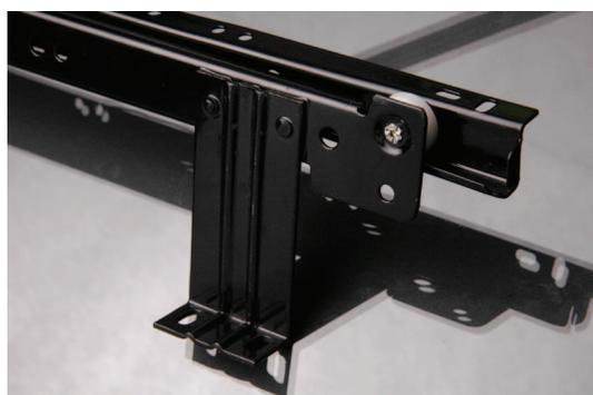
Fabricada en chapa de acero laminada en frío calibre 18. Con recubrimiento de pintura electrostática negra, con rodamiento de Nylon D 18 mm. Utilizada como elemento rodante para portateclados.
