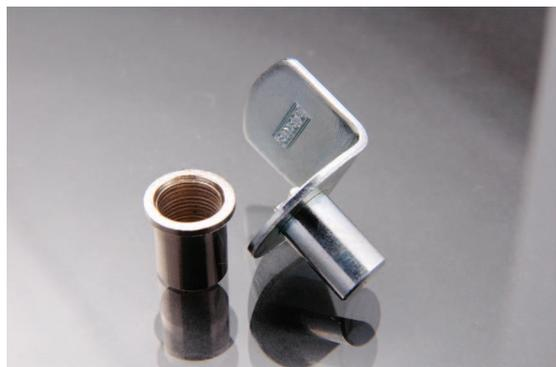
Fabricado en chapa de acero laminado en frío calibre 18. Con remache D ¼". Con recubrimiento electrolítico de Zinc Azul. Utilizado para soportar entrapaños de bibliotecas, bares, muebles, etc.
