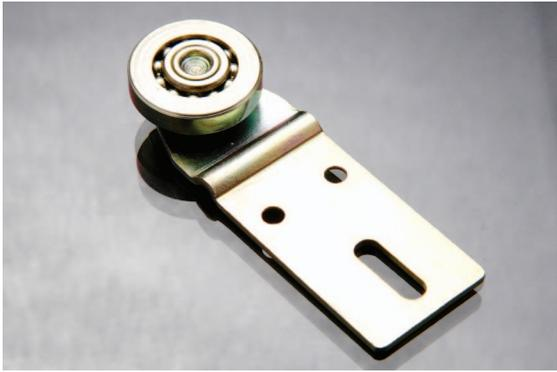
Fabricado en chapa de acero laminado en frío calibre 14. Con recubrimiento electrolítico de Zinc Iris, con rodamiento liso de D 1". Utilizables en puertas corredizas.
