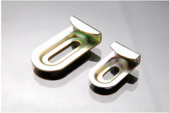
Fabricado en chapa de acero laminado en frío calibre 18. Con recubrimiento electrolítico en Zinc Iris. Utilizado para colgar cuadros y fijar espejos de baños. Cuenta con dos presentaciones, soporte de uña pequeño y Soporte de uña grande (ref. SB-50 U-2).
