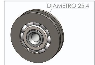
Fabricado en acero 1020 - D 1 1/4", rodamiento montado en esferas de acero de D 5/32". Utilizado como accesorio en la fabricación de rieles y mecanismos de rodamiento para gavetas de archivero y cajones de escritorio, resiste mayor peso que las referencias anteriores. Acabado con baño electrolítico de Zinc Azul.
