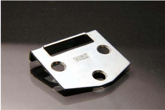
Fabricada en chapa de acero laminada en frío calibre 18. Con recubrimiento electrolítico de Zinc Azul. Diseñada para dar refuerzo a los muebles grandes.
