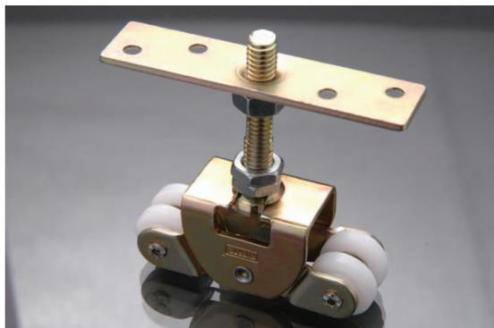
Fabricado en chapa de acero laminado en frío calibre 14. Con recubrimiento electrolítico de Zinc Iris. Diseñada en brazos escualizables y rodamientos silenciosos de Nylon. Se recomienda para puertas sencillas, bipartidas o dobles de  $\frac{3}{4}$ " y  $1\frac{3}{4}$ " de espesor.
