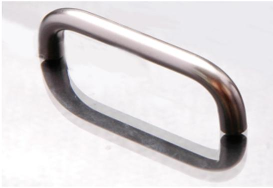
Fabricada en acero 1020 - D 3/8". Tiene un longitud entre centros de 212 mm. Distancia a la puerta después de instalada 23 mm. Acabado con recubrimiento electrolítico de níquel.
