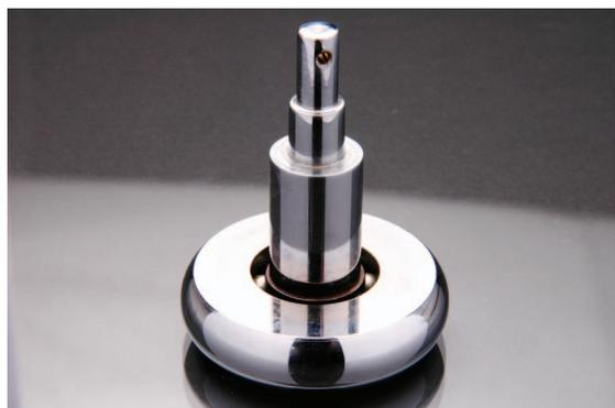
Fabricado en acero 1020 - D 47,4 mm con eje de 57,2 mm de longitud. Utiliza esferas de acero de 1/4". Protegido contra la oxidación con recubrimiento electrolítico de Zinc Iris. Es utilizado en puertas automáticas para garaje.
