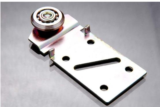
Fabricado en chapa de acero laminado en frío calibre 14. Con recubrimiento electro-lítico de Zinc Iris, y rodamiento de D 1" biselado para ser utilizado según el riel, en puertas sencillas bipartidas o pasantes de 3/4" de espesor. Especiales para closets, armarios, paneles de almacenaje y puertas comunicantes.
