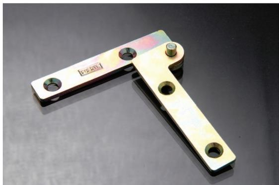
Fabricada en chapa de acero laminada en frío calibre 12. Con recubrimiento electrolítico de Zinc Iris. Adecuada para puertas con peso hasta de 20 kg.
