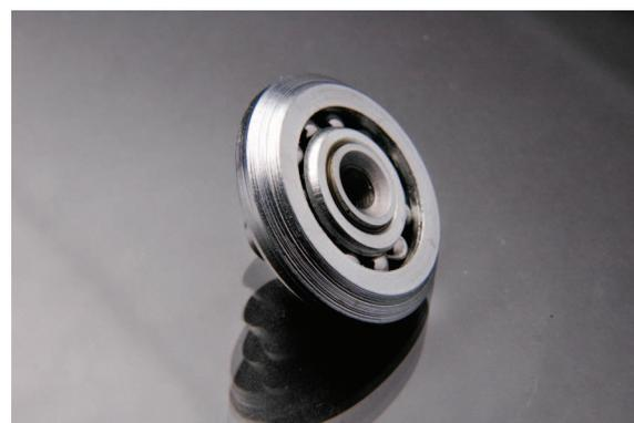
Fabricado en acero 1020 - D 1", emplea esferas de acero de D 5/32". Es utilizado como accesorio corredizo en la fabricación de herrajes donde el riel utilizado tiene forma de "V". Acabado con recubrimiento electrolítico de Zinc Azul.
