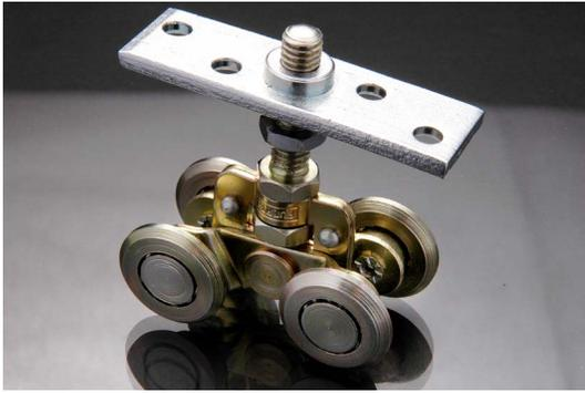
Fabricado en chapa de acero laminado en frío calibre 14. Con recubrimiento electrolítico de Zinc Iris. Diseñada con 4 brazos escualizables y 4 rodamientos biselados metálicos de D 1 1/8". Utilizables en puertas corredizas, pasantes o bipartidas.
