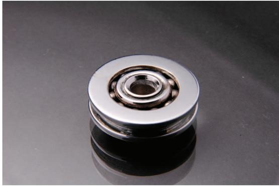
Fabricado en acero 1020 - D 1". Es utilizado como accesorio para la fabricación de reglas paralelas e instrumentos didácticos para laboratorios de física (polipastos, poleas, etc.) La ranura mide 2,5 mm de ancho y 2,2 mm de profundidad. Acabado con baño electrolítico de Zinc Azul.
