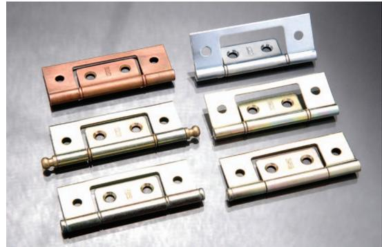
Fabricada en chapa de acero laminada en frío calibre 16. Con recubrimiento electrolítico de Zinc Iris. Permite un ángulo máximo de apertura de 180°. Esta diseñada para puertas con peso hasta de 40 kg.
